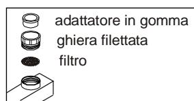
L'accessorio per manipoli è formato da un adattatore in gomma (di diverso diametro per differenti tipi di manipoli), una ghiera filettata e un filtro all'interno.
